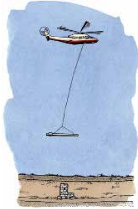
Helikopter jeofiziğinde, "kuş" denilen cihazdan yerin içine değişik frekanslarda elektromagnetik dalgalar gönderilir. Yerin farklı derinliklerine nüfuz eden bu dalgalar geri yansır ve ölçülür.
